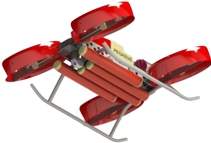
БВС Pegasus-75 с гидробуями Полезная нагрузка 48 кг
