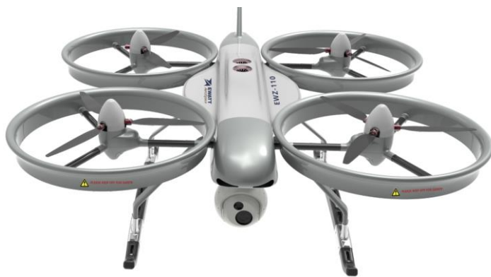
Квадрокоптер с управлением шагом винтов и электрической трансмиссией
