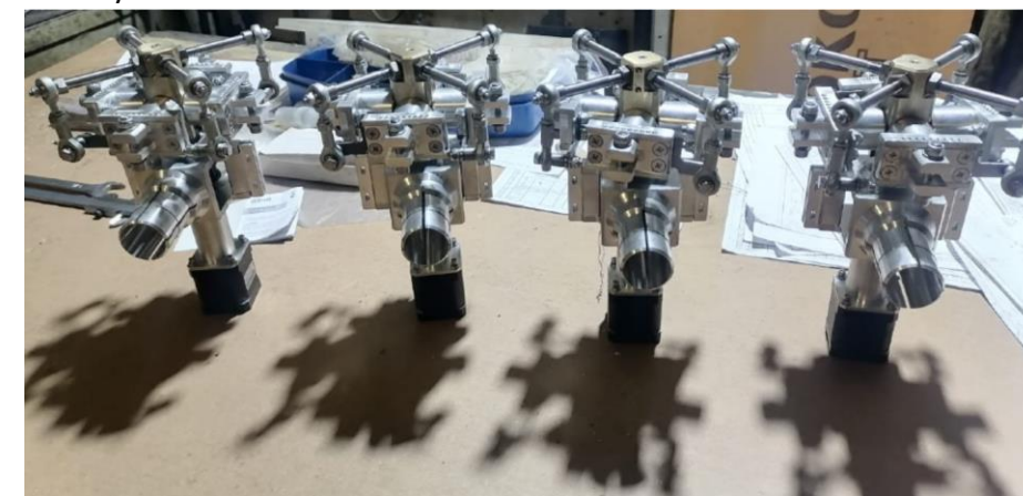
Собранные автоматические ВИШ для установки на разрабатываемый транспортный БВС
