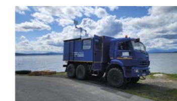
Мобильный центр управления системой «Безопасность-Шельф» организован на базе автомобиля КАМАЗ на шасси повышенной проходимости (НПЦ «Кылья Сахалина»)
