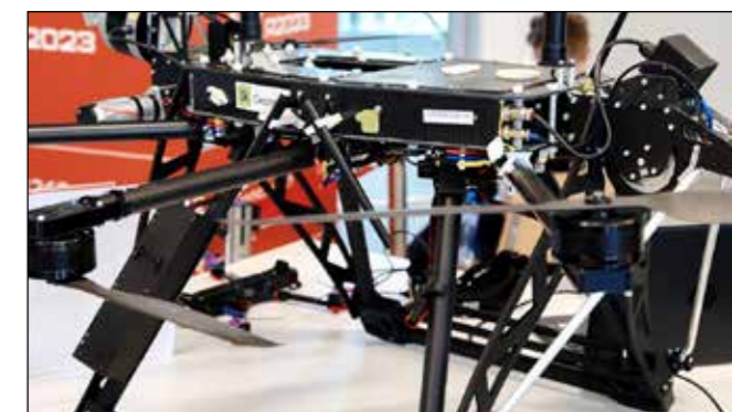
БАС «Стрекоза» реализована по схеме «Тайлситтер». Автоматический вертикальный взлет самолета без катапульты. Имеет высокие аэродинамические качества.
