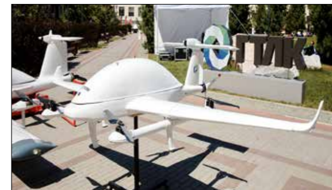
Беспилотные воздушные суда T-300 и TFM-15 коммерческого класса представила московская компания «Летающие Машины Тюринга». Это аппараты самолетного типа с вертикальным взлетом и посадкой.
