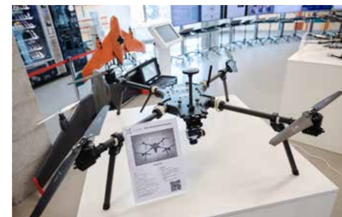
Муха М1 беспилотник мультироторного типа от «Лаборатории будущего». Может применяться для наблюдения или доставки грузов весом до 6 кг. Максимальная скорость – 60 км/ч, а время полета – до 45 минут.
