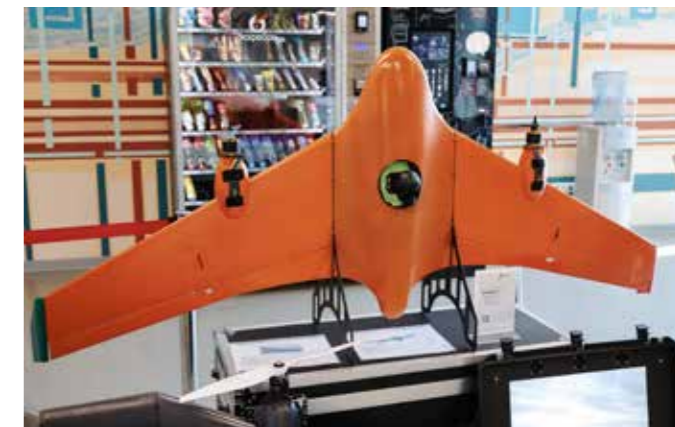
Стрекоза 1 может работать в городе и на местности с ограниченной площадкой взлета/посадки благодаря конструкции по схеме «Тейлсitter». Энергоэффективность разработки позволила увеличить высоту, дальность и длительность полета.
