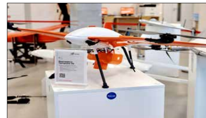
Винтокрыл Optiplane S2 гибрид самолета и копитера. Производителнее копитеров в 3 раза. Не требует квалификации пилота, в отличие от БПЛА самолетного типа.
