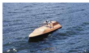
Безэкипажный катер контроля акватории и противодействия угрозам (БЭК-П)
