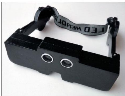
Рис. Устройство на основе эхолокации для ориентирования в пространстве слепых и слабовидящих
