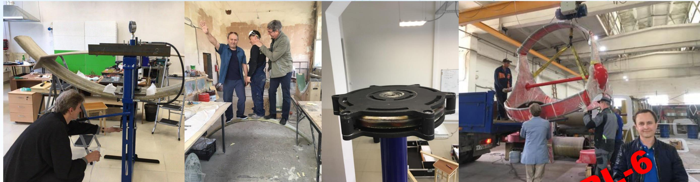
Благодаря изогнутым лопастям, наш ветроротор имеет существенно большую прочность при минимальных размерах и способен предотвращать саморазгон при сильных ветрах.
