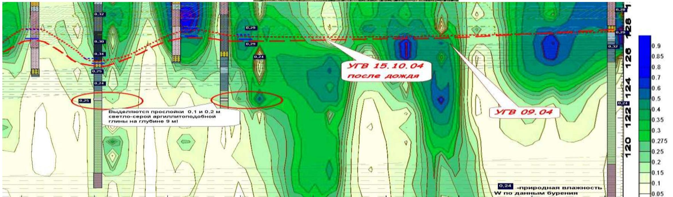
КОЛИЧЕСТВО СЛОЕВ, МЕСТОПОЛОЖЕНИЕ, МОЩНОСТЬ В КОЛОНКАХ И МОДЕЛИ СОПАДАЮТ. ВЫЯВЛЕН СЛОЙ 0,1-0,2 м НА ГЛУБИНЕ 9м В ГЛИНАХ. ВЫДЕЛЯЕТСЯ НАСЫПНОЙ ГРУНТ, ВЛАЖНЫЕ И ТУГОПЛАСТИЧНЫЕ СЛОИ. МОДЕЛЬ С ТОЧНОСТЬЮ ДО ЕДИНИЦ % ОТОБРАЖАЕТ РАСПРЕДЕЛЕНИЕ МИНЕРАЛИЗОВАННЫХ ВОД В ТЕЛЕ ОПОЛЗНЯ В СРАВНЕНИИ С ЕСТЕСТВЕННОЙ ВЛАЖНОСТЬЮ 18 ОБРАЗЦОВ КЕРНА.
