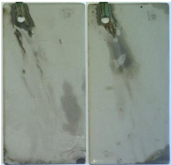
Образцы покрытий после 20 суток в камере соляного тумана, 35 °C
