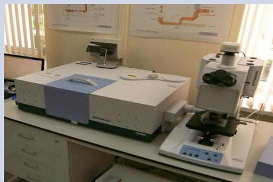
ИК-Фурье спектрометр Bruker VERTEX 80/80v
