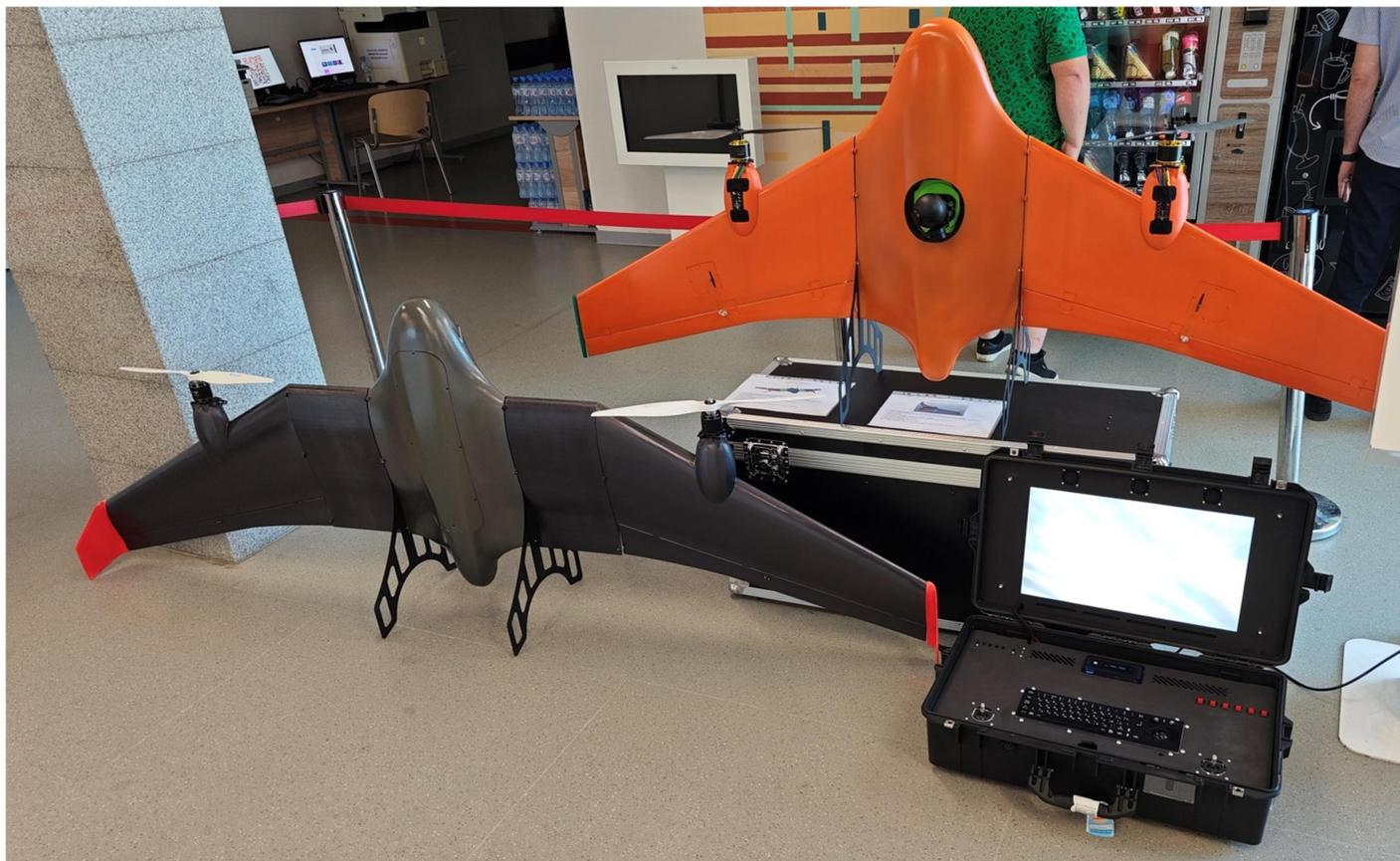
Поэтому был оставлен объемный фюзеляж, но он был усовершенствован для создания большей подъемной силы, использовано плоское дно и усовершенствована форма носа, он стал более плоским и заостренным, что увеличило аэродинамическое качество более чем на 15% и добавило не менее 10 дм кв к общей несущей площади крыла. Т.е. фюзеляж стал частью крыла и сам стал создавать подъемную силу. Что подтвердили тесты проведенные в программе Ansys.
