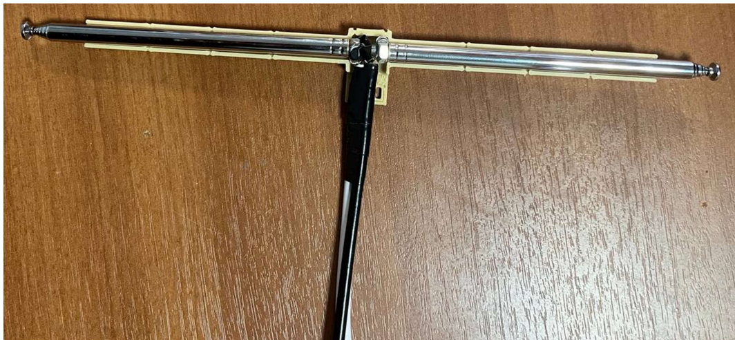
Рис 6. Сборка антенны в корпус
