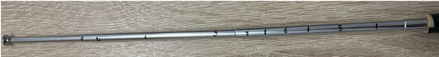
Рис 8. Изображение частотной линейки на антенне
