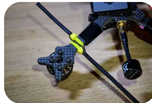
Рис 3. Крепления из стяжек. Антенну располагать перпендикулярно направлению полета в горизонтальной плоскости.
