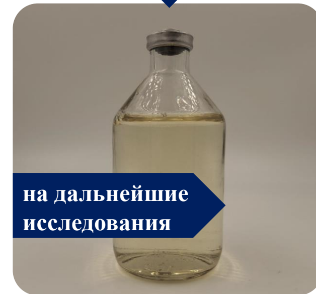
Рисунок 5 – Синтезированный электролит \text{LiAlCl}_4 \times \text{SO}_2
