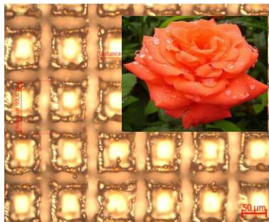
Лазерно-индуцированные биомиметические структуры на примере супергидрофобных поверхностей лотоса и розы
