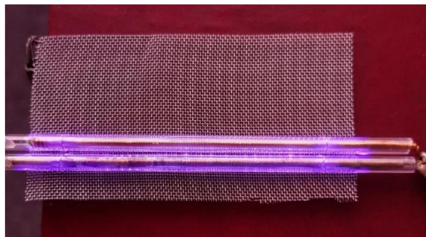
Плоский плазмагенератор для бытовых рециркуляторов
