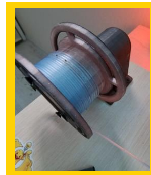
Блок намотки готового прутка на катушку
