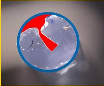
Дефект в виде полости
