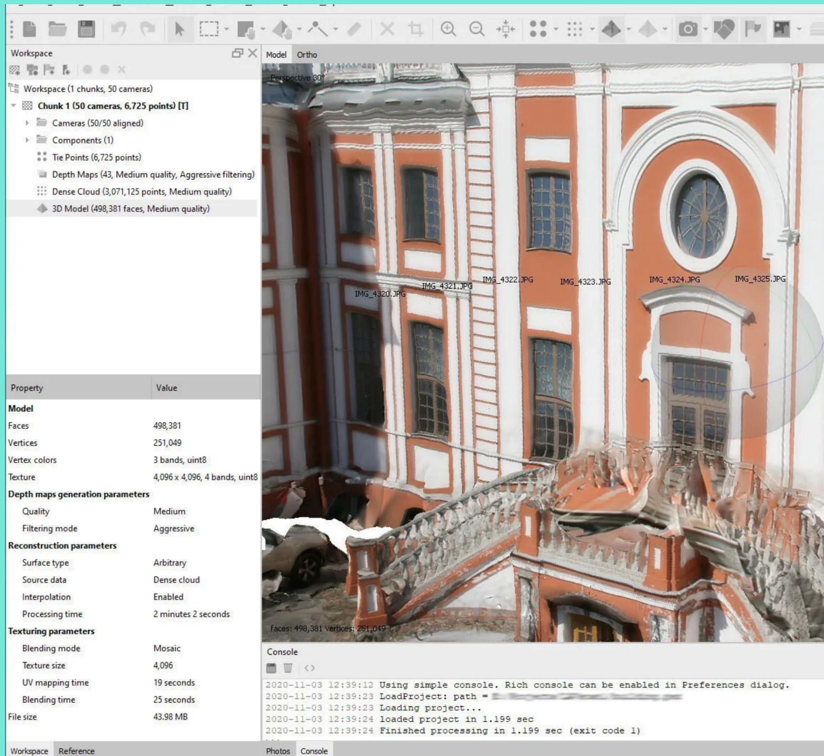
Процесс обработки данных автоматизирован с помощью профессиональных приложений, например: Agisoft Metashape, 3DF Zephyr Pro, VisualSfM и д.р. Данное приложение позволяет создавать географически привязанные плотные облака точек, текстурированные полигональные и тайловые модели, цифровые модели местности/рельефа и ортофотопланы на основании перекрывающихся цифровых снимков и информации о географических координатах.
