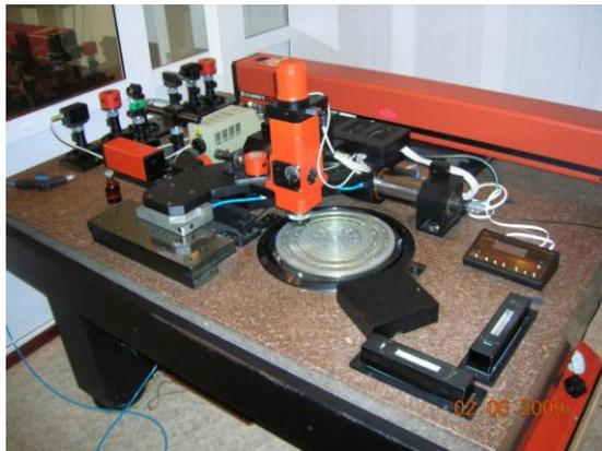
Лазерный генератор изображений, для синтеза измерительного растра
