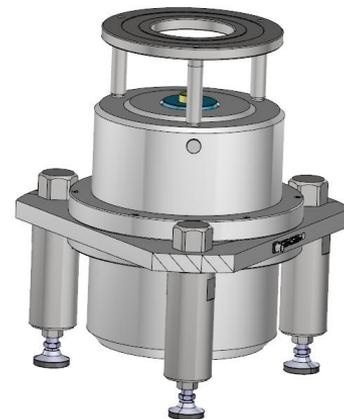
Углоизмерительная установка, для юстировки датчика (НИОКР Сколково)
