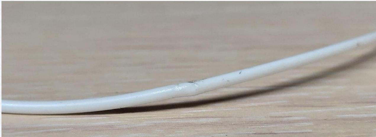
В 3D принтерах Diva-5 установлена система предупреждения окончания филамента, которая самостоятельно выполняет соединение окончания катушки, которая заканчивается с началом новой катушки, без участия оператора 3D-принтера.
