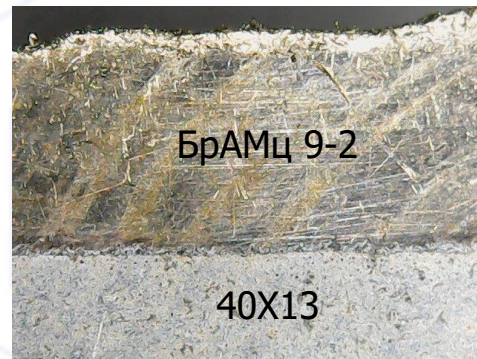
Микрофотография бокового шлифа образца после напыления фрикционного покрытия (БрАМц 9-2)
