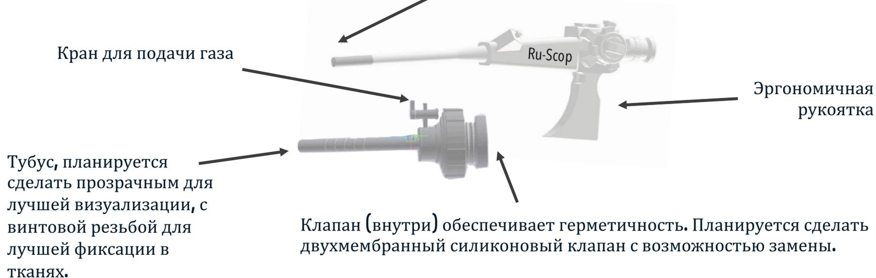
Линейка размеров: тубусы диаметром от **5** до **20** мм. Длина тубуса: от **7** до **15** мм.
