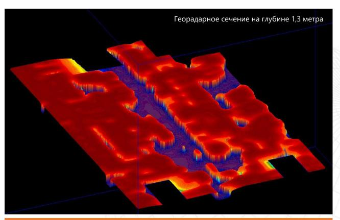
Внутри склада выполнен 31 георадарный профиль через 1 м и шагом 10 см. 3Д модель показывает обширную зону оттайки грунта вдоль линии фундамента центральных опор шириной 3–4 м и несколько локальных зон оттайки под внешними опорами.
