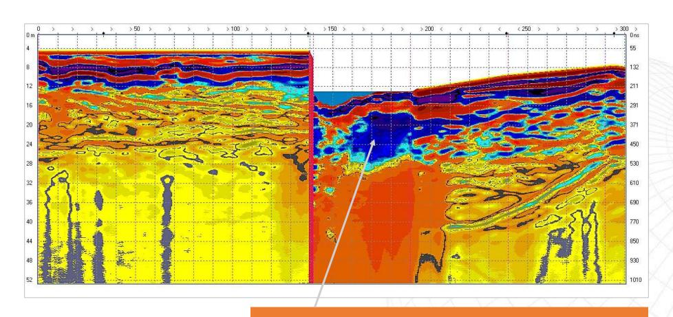
В массиве вечномерзлого грунта обнаружена обширная талая зона на трассе прокладки газопровода под рекой за Полярным Кругом
