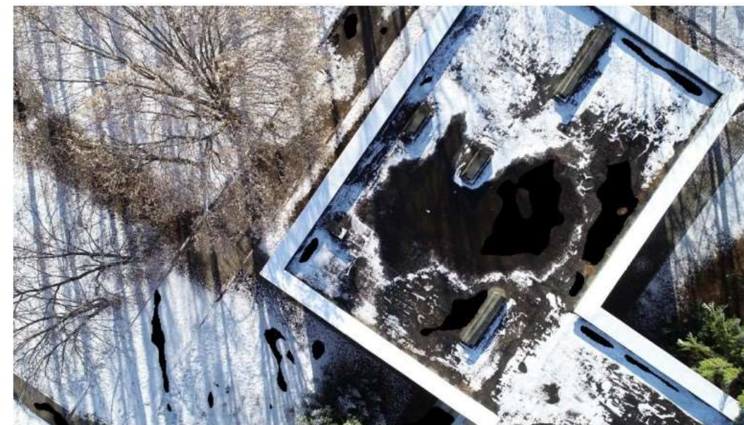
Рисунок 2.10 – Карта дефектов кровли
