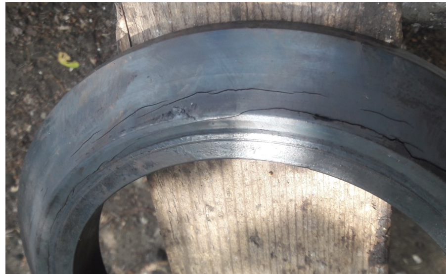
Рисунок 3 – Основные неисправности клапана сливного прибора
