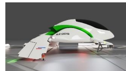
БВС с распределенной силовой установкой, вертикальным взлетом и посадкой
