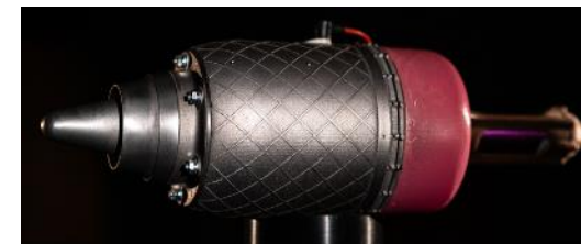
Турбореактивный двигатель тягой 10 кгс
