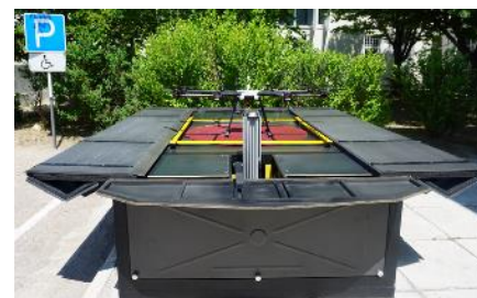
Универсальная роботизированная платформа для базирования и обслуживания дронов массой до 100 кг
