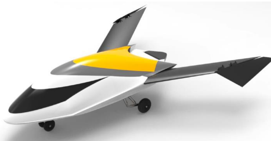
Проект «3 по 500». Полезная нагрузка 500 кг. Дальность 500 км. Скорость 500 км/ч. Цена- 38 млн. Руб. СВВП*
