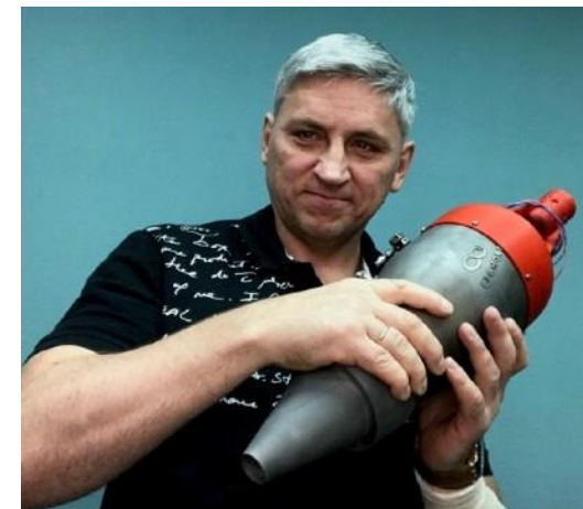
Турбореактивный двигатель тягой 10 кгс
