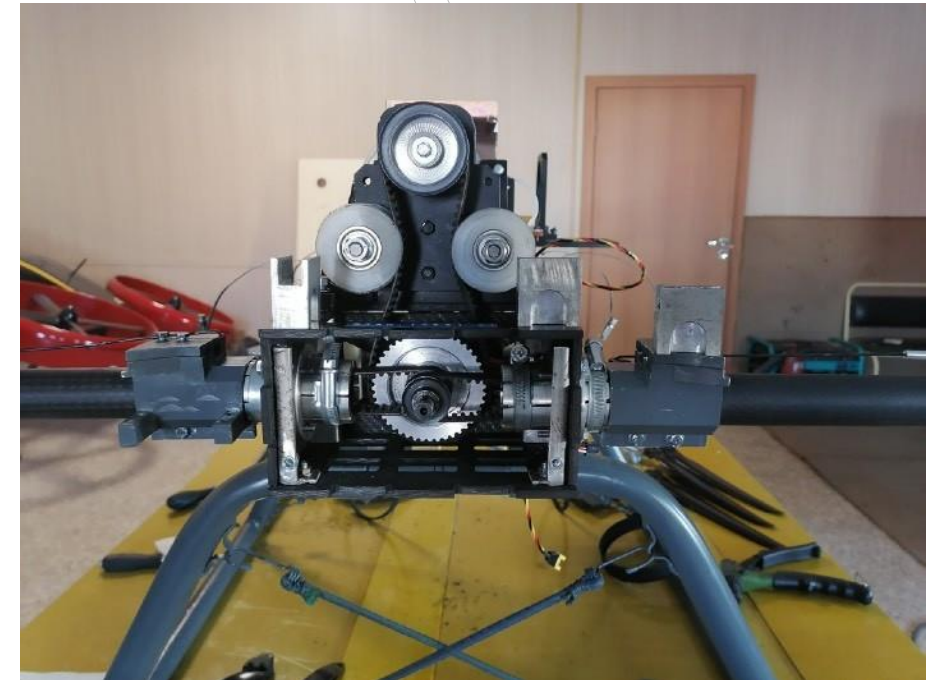
Стенд «КУЛОН» для отработки механической трансмиссии
