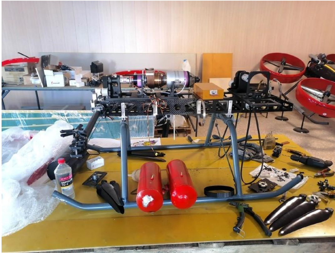
Сборка станда для исследования взлетно-посадочных режимов
