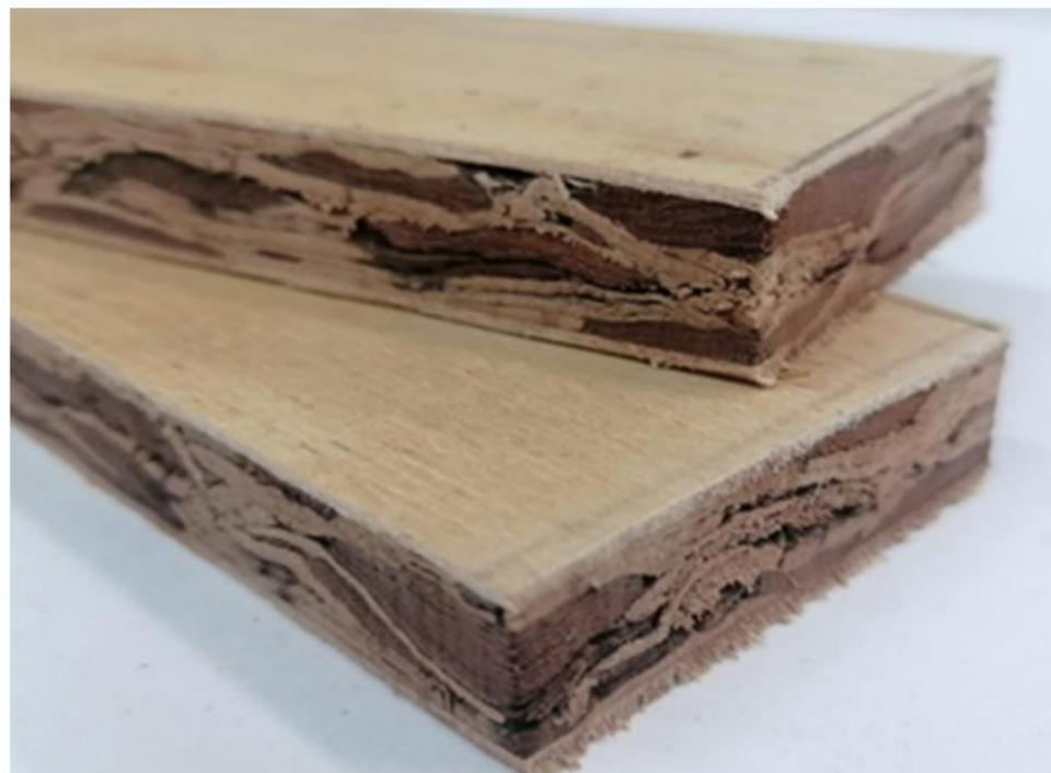
Этот материал может быть изготовлен только из одной коры путем ее прессования и является экологически чистым продуктом. Кора позволяет повысить стойкость плитного материала к влаге по сравнению с древесностружечными плитами. Для повышения прочностных характеристик плитного материала необходимо при прессовании вводить связующее вещество.
