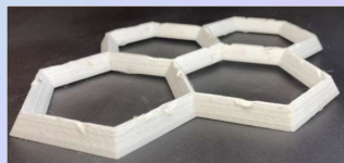
Повреждения образца 3D-георешетки
