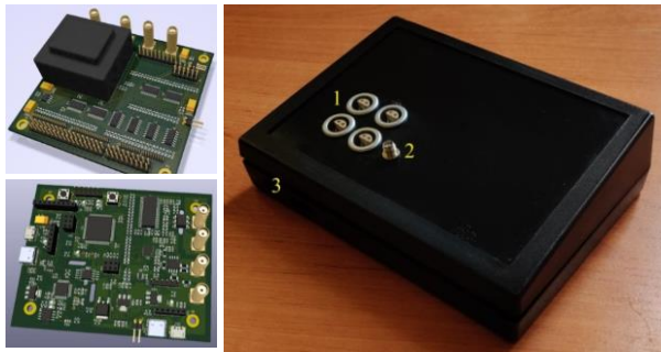
Томограф использующий принцип электроимпедансной томографии собственной разработки
