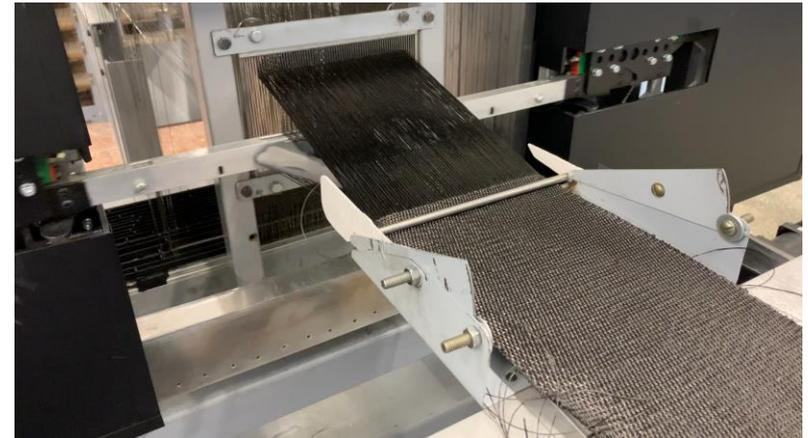
Для изготовления цельнотканых объемно армированных преформ используются специализированные ткацкие станки, адаптированные под производство объемных изделий, изменяющихся в процессе ткачества по ширине, толщине и профилю.
