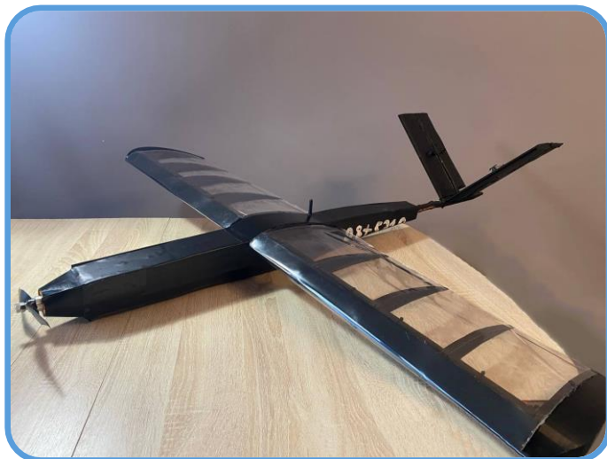
Рис. 1. Опытный БПЛА для испытания работы крыла
