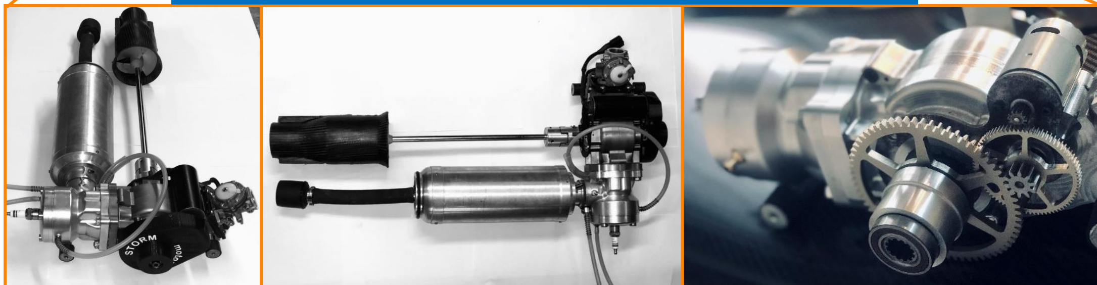
Двигатель на основе ДВС и водомета собственной разработки
