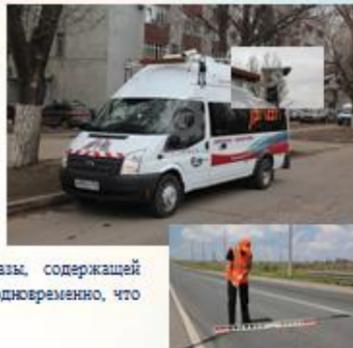
Оперативную и наиболее ёмкую информацию для оценки состояния дорожного полотна можно получать, используя в совокупности авто-лабораторию и комплекс беспилотных летательных аппаратов (БПЛА), оборудованный приборами дистанционного зондирования объектов.
