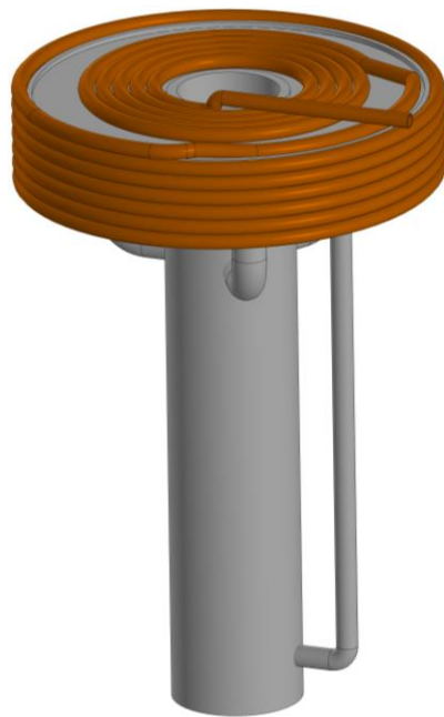
№1 – Кристаллизатор с замкнутым испарительно – конденсационным контуром (Патент № 2739358 РФ Оpubл. 23.12.2020 Бюл. №36)
