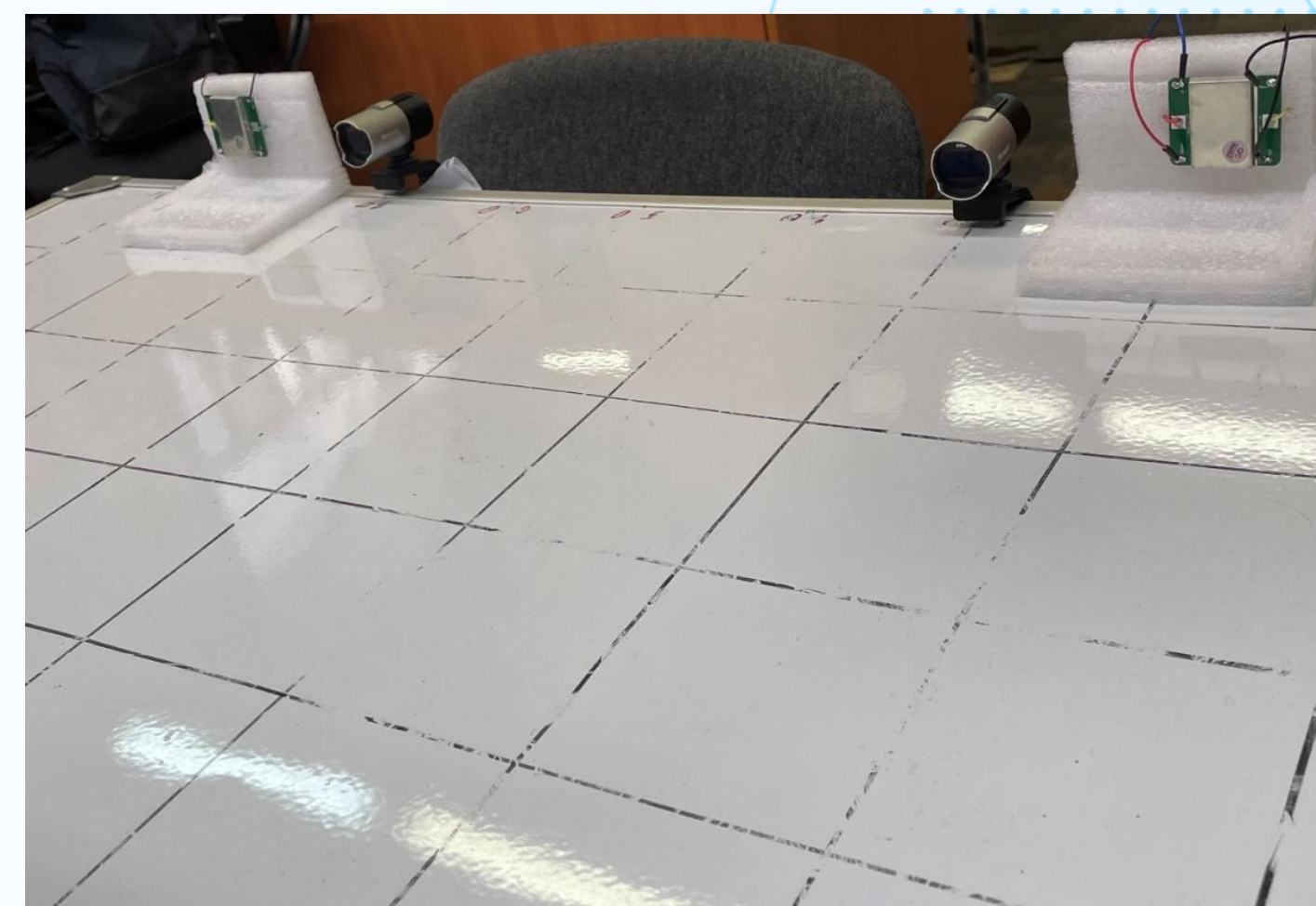
Рисунок – Датчик NB100 и оптическая камера, расположены на стенде
