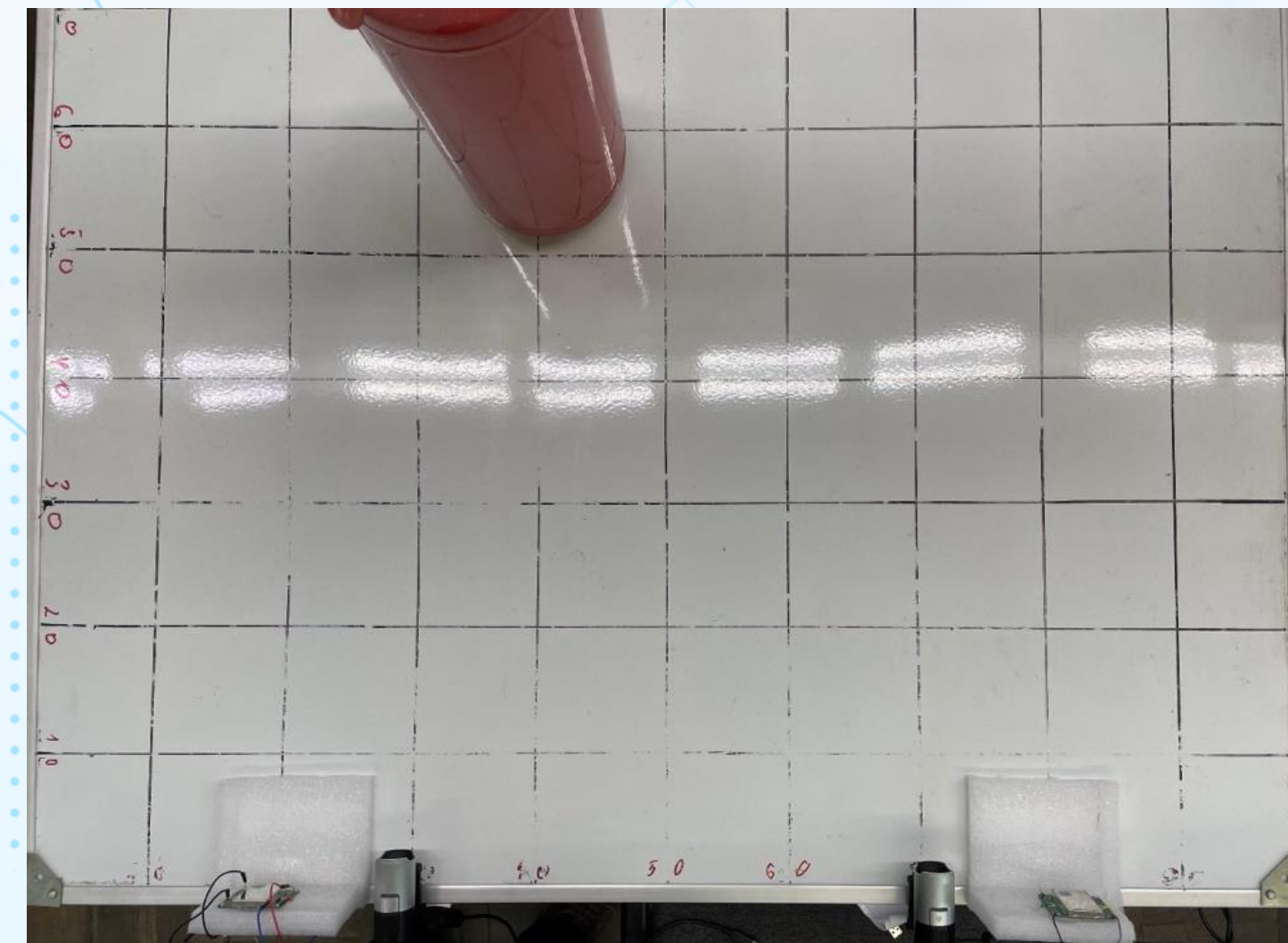
в) датчик NB100 и оптическая камера расположенные на стенде
