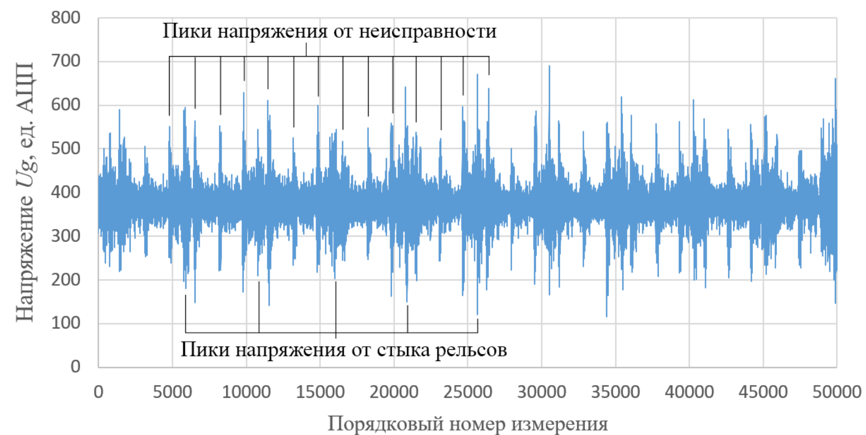
Сигнал неисправной КП (навар 1,6 мм)
