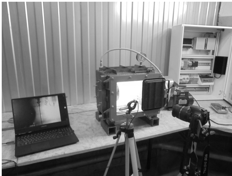
Рис. 1. Эксперимент на стенде МСИД (испытания модельного отражателя и подвески мишени, моделей «Фейерверк», «Оригами», «Импульс-0»)
