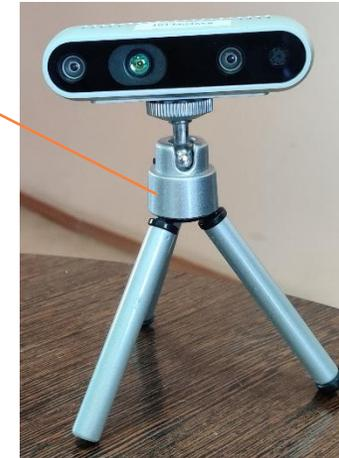
Камера анализирует углы и «правильность» ходьбы пользователя. Строит графики углов
