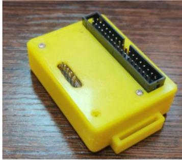
Аппаратный модуль. Собирает данные со стопы и передает их на ПК или смартфон. Через шлейфовое соединение модуль подключается к «стельке». Передача данных осуществляется с помощью Bluetooth соединения
