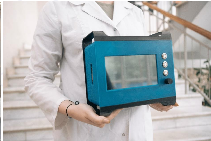
ЭИТ томограф (прототип). Размеры ~ 200*150*200 мм. Вес < 2 кг.
