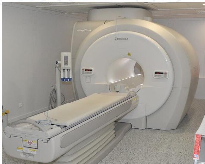
Традиционный МРТ томограф. Размеры ~ 2 комнаты. Вес ~8000 кг. + серверы для расчета и визуализации
