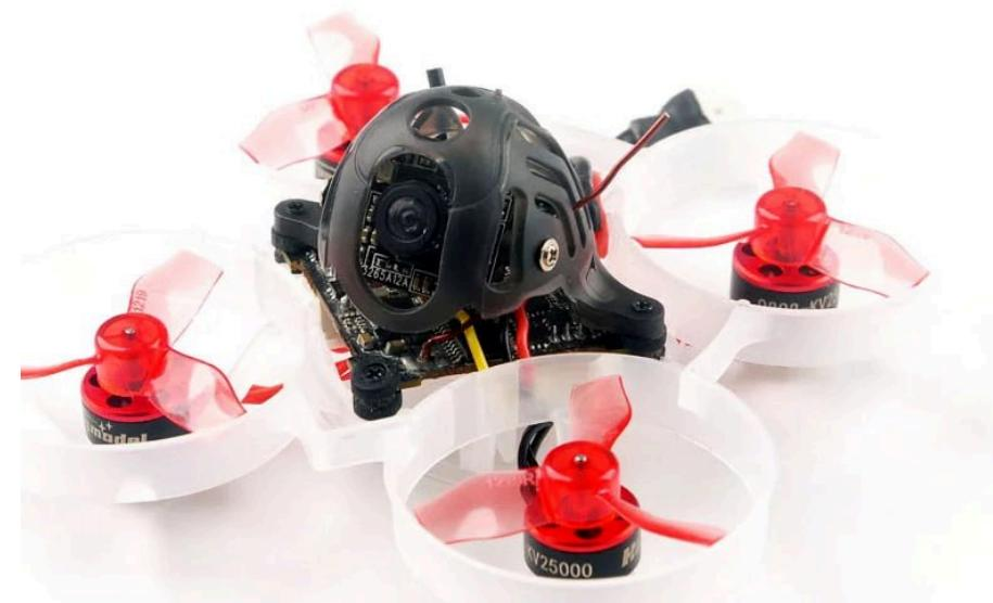
**ГЛАВНОЙ ЗАДАЧЕЙ БЫЛО РАЗРАБОТАТЬ КОМПАКТНЫЙ, ЛЁГКИЙ И МОЩНЫЙ ДРОН. ДЛЯ РЕАЛИЗАЦИИ ВЫБРАН ПОЛЁТНЫЙ КОНТРОЛЛЕР AIO СОДЕРЖАЩИЙ В СЕБЕ РЕГУЛЯТОР ОБОРОТОВ, ВИДЕО ПЕРЕДАТЧИК И ПРИЁМНИК. ПК ИМЕЕТ ВЕС 5,1Г, FPV КАМЕРА - 2Г. ВЫБОР КОМПОНЕНТОВ ЗАВИСЕЛ ОТ ЭНЕРГОПОТРЕБЛЕНИЯ, ВЕСА И РАБОТЫ В РАЗЛИЧНЫХ УСЛОВИЯХ.**
