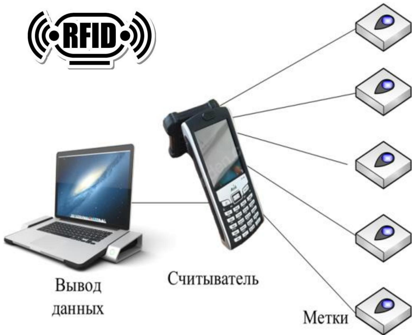
**RFID** (англ. **Radio Frequency Identification**), радиочастотная идентификация - способ автоматической идентификации объектов, в котором посредством радиосигналов считываются или записываются данные
