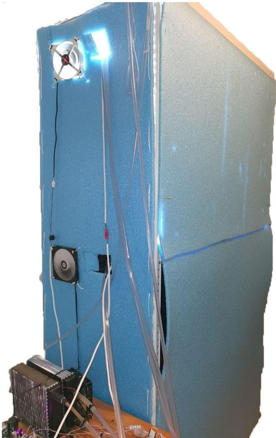
Тестовый экспериментальный образец лабораторного модуля “Neck” представляет собой разборный бокс, состоящий из металлического каркаса и стенок из влаго- и
